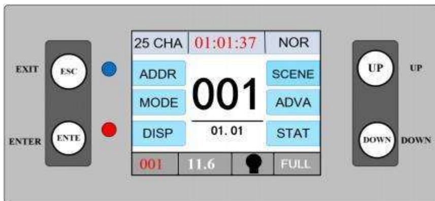
Figura 3 Diagramma del pannello di visualizzazione a pulsante a molla
